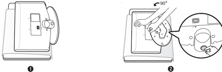
1. Placer l'avant du téléviseur sur un chiffon doux ou un coussin posé sur une table (voir figure ❶).
